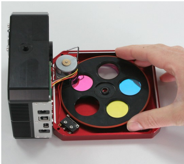
Abbildung 2: Aufbau der CCD Kamera mit Filterrad (links (Ati15)) und Filterkurven der photometrischen UBVRI -Filter nach Bessel (rechts (Baa19))
